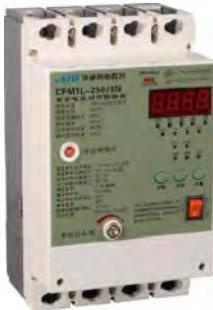
CFM1L系列剩余电流动作断路器是一体式，多功能，负荷电流可调的漏电断路器。适用于三相四线中性点直接接地(TT)的低压电网，用来对人身触电危险提供间接接触保护，也可对线路或用电设备的接地故障，过电流、短路，欠电压，过电压，缺相和电源侧断零线等进行保护。
